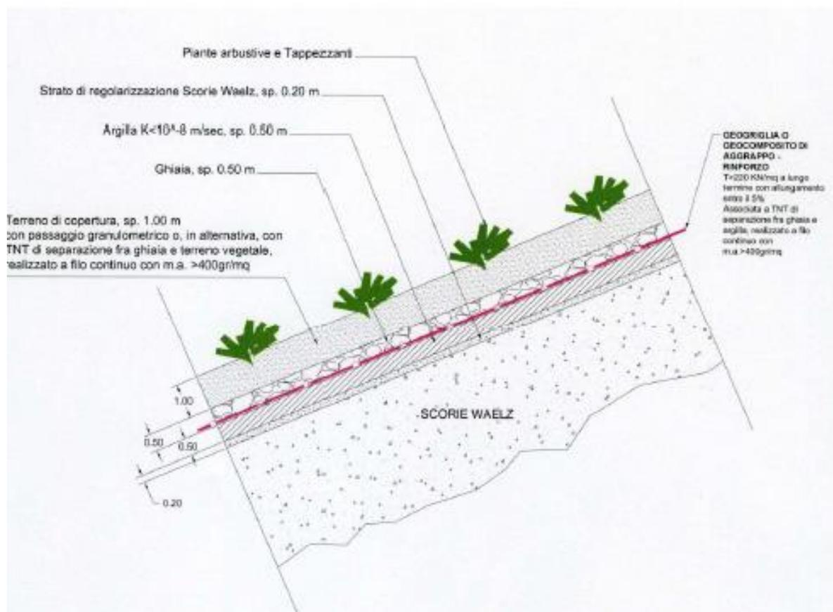
E' stato previsto di mantenere l'attuale limite di 23° per l'inclinazione massima delle scarpate. La posa del capping verrà effettuata per una prima parte nell'area a monte, al termine del conferimento delle scorie del I° lotto, il completamento avrà luogo al termine del conferimento delle scorie del II° lotto.
