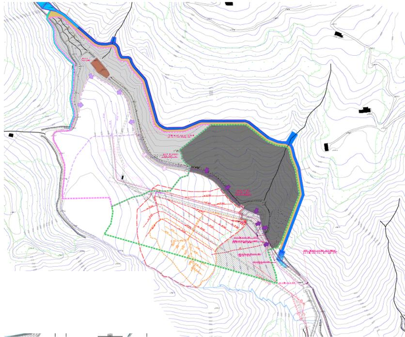
Sarà necessario lo spostamento della tubazione che convoglia il percolato all'impianto di depurazione per un tratto di circa 120 metri tra il I e il II ponte della pista di accesso dalla sponda sinistra dell'alveo del Rogno al margine occidentale della pista di servizio a causa della realizzazione della vasca di valle del nuovo alveo del Rogno.
