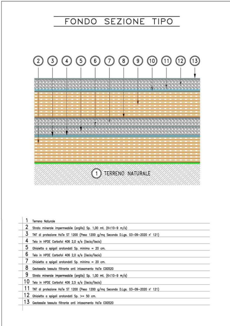
Per l'impermeabilizzazione delle sponde (fondo inclinato) la norma prevede che "particolari soluzioni progettuali nel completamento della barriera geologica potranno eccezionalmente essere adottate e realizzate anche con spessori inferiori a 0,5 m, a condizione che garantiscano comunque una protezione equivalente e previa approvazione dell'ente territoriale competente" ovvero dovrà essere garantito un tempo di attraversamento della barriera non inferiore a 150 anni.
