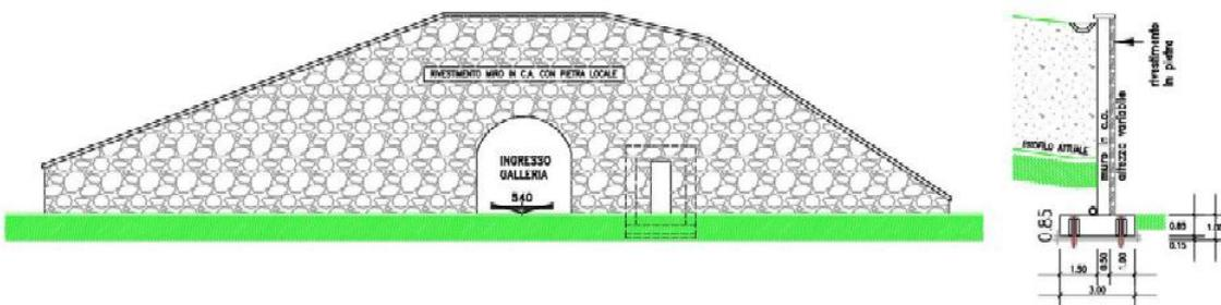
Il muro sarà in cemento armato con rivestimento in pietrame. La fondazione del muro, con larghezza pari a tre metri e spessore pari a 0,85 metri, sarà impostata su micropali di lunghezza pari a 10 m disposti ad interasse di due metri ed ancorata mediante un doppio ordine di tiranti. Il muro prevede un tratto centrale quale sovrizzo di 2,40 metri del portale d'ingresso della galleria e due muri d'ala che raggiungono un'altezza massima di 7,82 metri. La Ditta ha trasmesso la relazione di calcolo.
