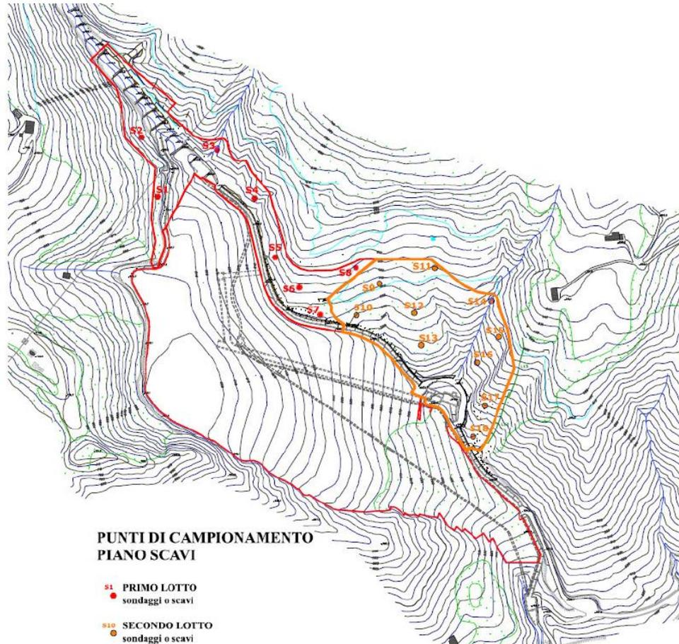
Per quanto concerne gli sbancamenti connessi all'esecuzione del lotto 1 (15.127 m<sup>2</sup>), si prevede la realizzazione di 8 punti di indagine da eseguirsi a carotaggio continuo o con escavatore meccanico. Per quanto concerne gli sbancamenti connessi all'esecuzione del lotto 2 (21.475 m<sup>2</sup>), si prevede la realizzazione di 10 punti di indagine da eseguirsi a carotaggio continuo o con escavatore meccanico.
